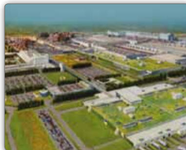
גג מפעל פורד בדירבון מינסוטה; תכנון ע"י וליאם מקדונהיו ומערכת צומח אקסטנסיבית על גג המפעל
